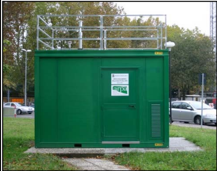
Stazione di monitoraggio della qualità dell'aria
