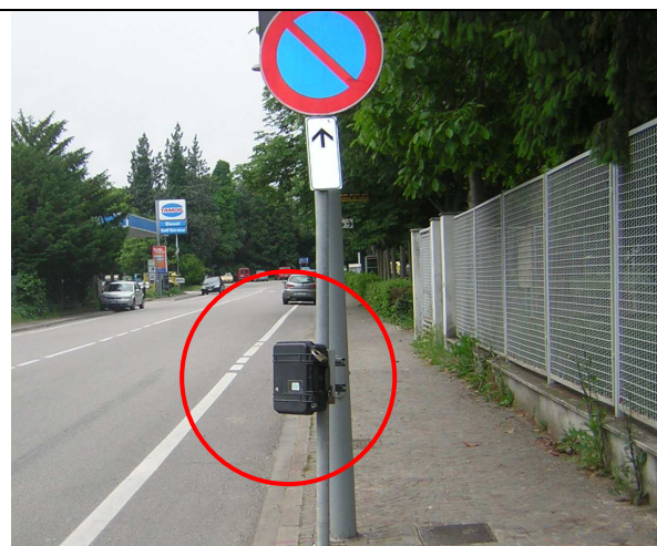
Foto.2: Contatraffico su via Carducci – particolare
