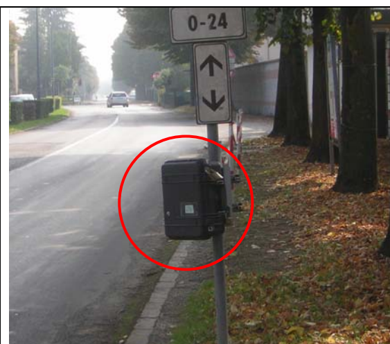
Foto.2: Contatraffico su via Agnini - particolare
