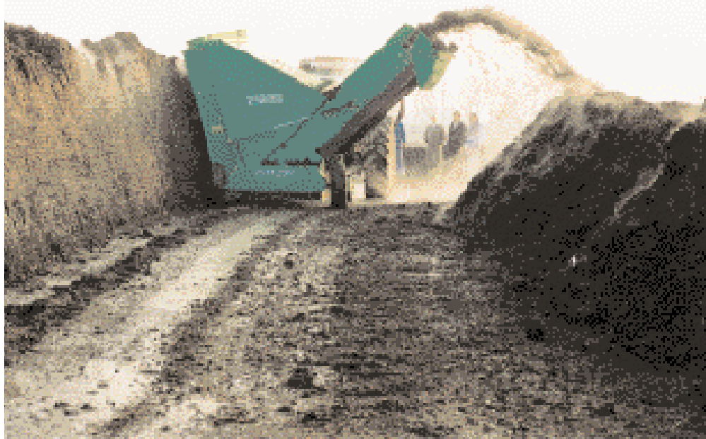
Foto 2 - E sempio di macchina rivoltatrice azionata da trattore idonea per cumuli a base larga.
