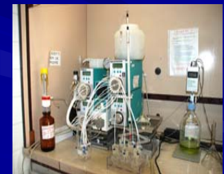
purificazione mediante cromatografia a permeazione di geli (GPC).
