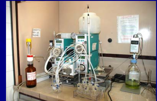
Purificazione mediante cromatografia a permeazione di geli (GPC).
