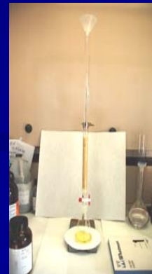
Eluizione su colonna circa 150 ml di \text{CH}_2\text{Cl}_2 (100 + 50)
