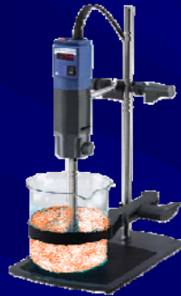
100 g di campione omogenati con circa 200 ml di acetone
