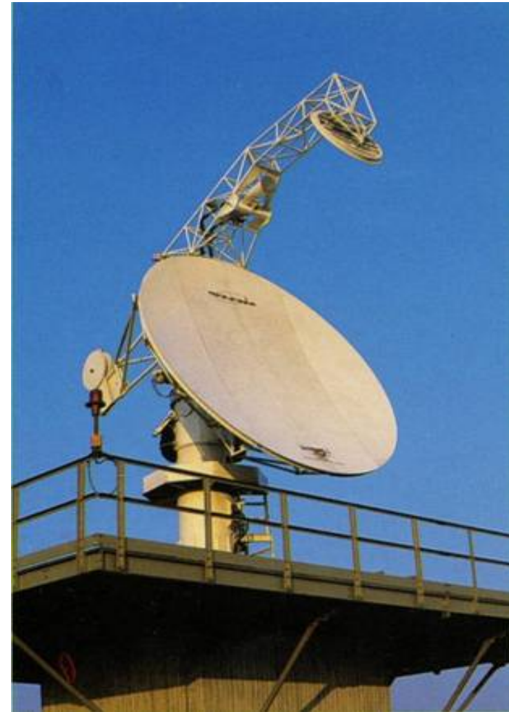
Rete radar: n. 2 radar GPM500 C
